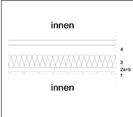
Lfd.Nr. **15** Bauteil Kürzel **DG-OG** Bauteil-Bezeichnung **Dachgeschoss oberste Geschossdecke**
