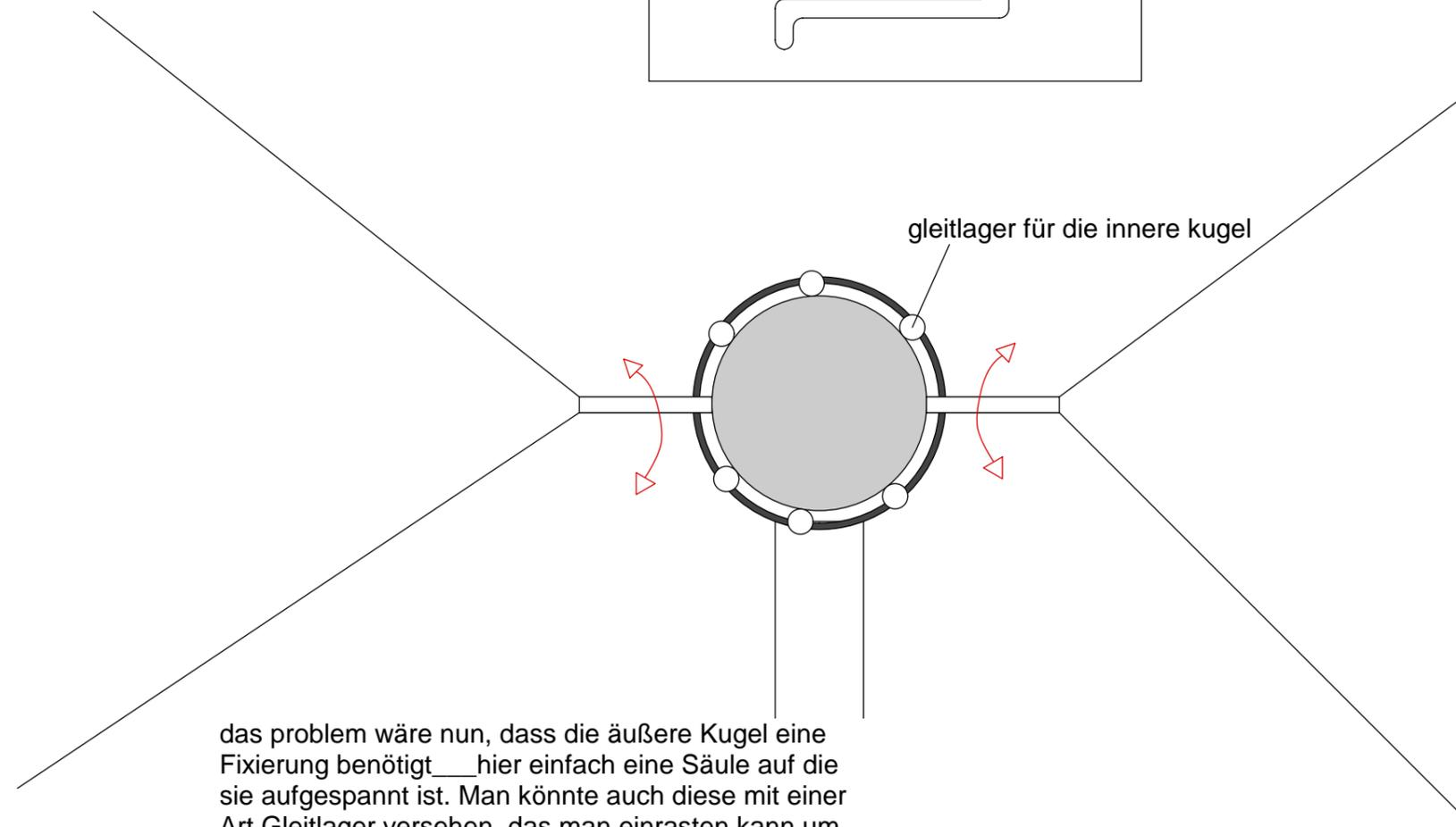
das problem wäre nun, dass die äußere Kugel eine Fixierung benötigt\_\_hier einfach eine Säule auf die sie aufgespannt ist. Man könnte auch diese mit einer Art Gleitlager versehen, das man einrasten kann um dem ganzen noch mehr Flexibilität zu verleihen indem man auch die äußere Kugel drehen kann
